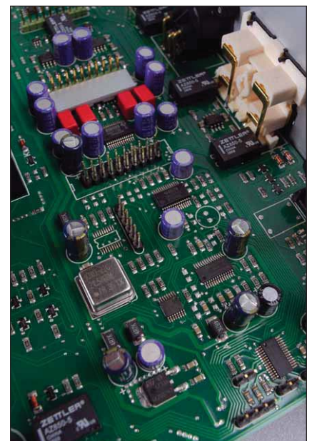
DAC und Quarz sind nahe beieinander, perfekt für jitterarmes Arbeiten
